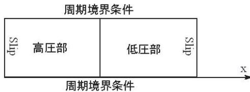
図-2 衝撃波管内流れ解析条件図
