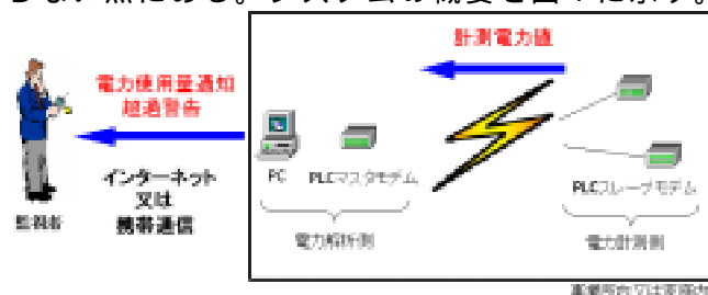
図1 PLCシステム概要
