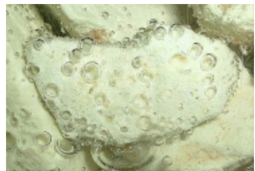
図-2 硫黄造粒物に付着した微細気泡
