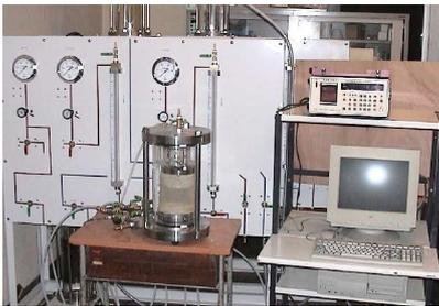
図-3 たわみ性壁透水試験機
