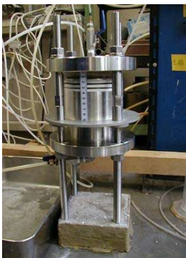
図6 膨潤量調節型透水試験機 (左:写真 右:構造)
