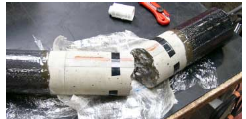
写真－4 破断状況（シート補強）
