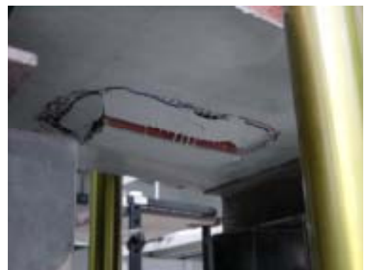
写真-2 押し抜き試験の状況
