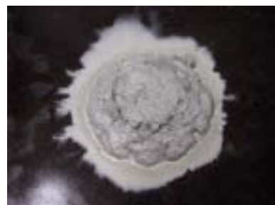
写真 1 モルタルと繊維の分離
