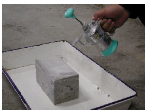
写真-1 塗布剤の施工状況
