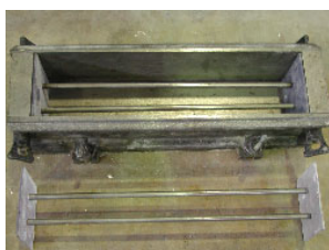
写真-2 供試体形状（鉄筋埋設形状）
