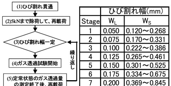
図-4 ガス透過試験の流れと Stage の分類
