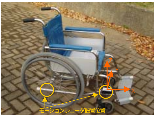
写真-1 測定に使用した車椅子と路面
