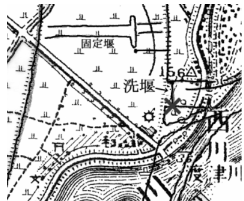
—：1974年発行の地形図による洗堰の右岸橋台と護岸 ×：洗堰右岸漏水発生箇所
