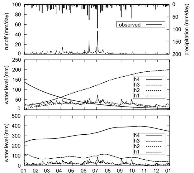
図-2 異なる定数による流出計算結果とタンク内水深の時間変化
