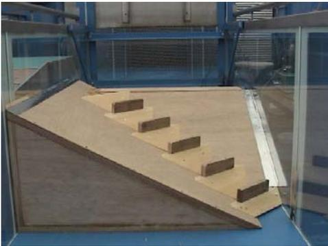
なお、本実験は提案魚道を多摩川調布堰右岸側に設置することを想定した模型実験(6分の1スケール)である。
