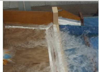
写真-1 副ダム背面傾斜角度 60 度以下
