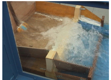
写真-2 副ダム背面傾斜角度 70 度以上
