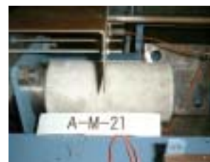
写真-1 空気浮上式重錘衝突実験装置 写真-2 コンクリート供試体
