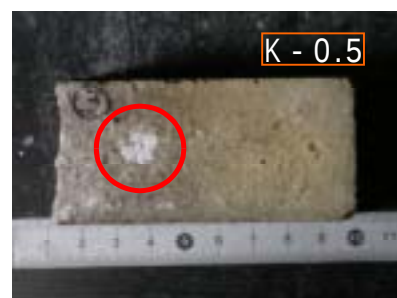
写真-1 モルタルの破壊状況
