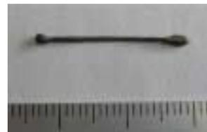
ステンレス繊維 B(形状:ドッグボーン,密度:7.93kg/m<sup>3</sup>,繊維長 23mm)
