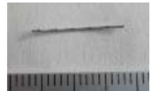
ステンレス繊維 A(形状:インデント小波付,密度:7.70kg/m<sup>3</sup>,繊維長:15mm)
