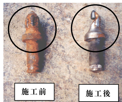
図-4 コニカルビット損耗状況
