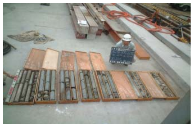
写真-3 出来形確認(コア採取試料)
