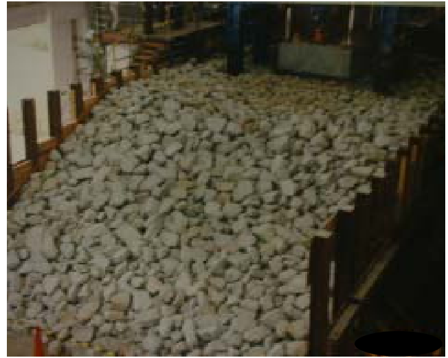
写真 - 1 捨石マウンドへの大型載荷実験
