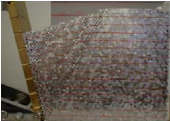
写真 - 1 φ 3.0mm の単一粒径のすべり破壊
