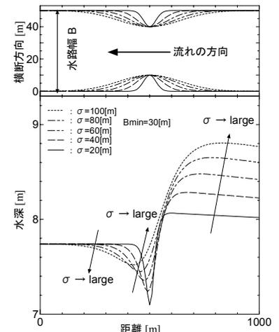
図-3 狭窄水路を流れる不等流の水面形 ( $\sigma$  変化)
