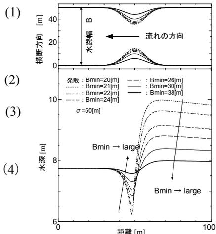
図-2 狭窄水路を流れる不等流の水面形 ( $B_{\min}$  変化)
