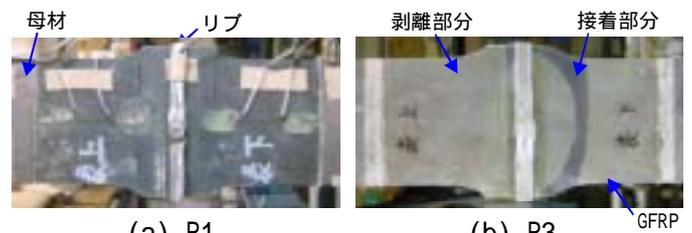
写真-1 GFRPの剥離状況
