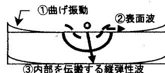
図3 鋼球打撃で発生する振動
