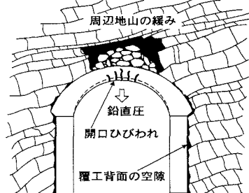
図-2 地山のゆるみによる変状模式図
