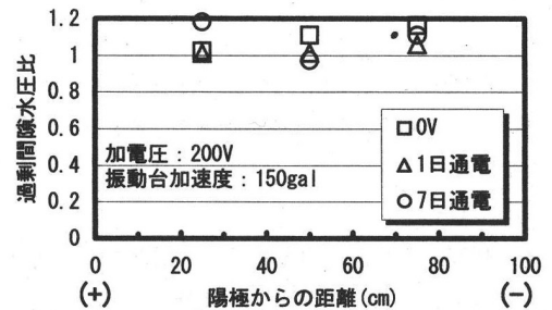
図-3 通电日数による過剰間隙水圧比の比較
