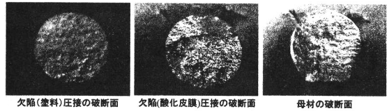
写真-1 各圧接継手の破断面
