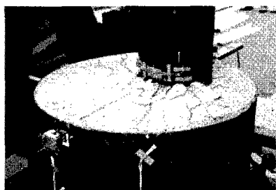
写真1 破壊状況 (S3実験終了時)
