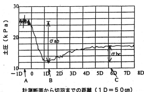
図-4 掘削試験における土圧変化の一例(LD=4Y)
