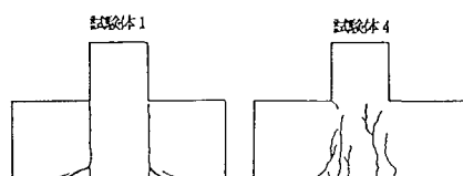
図-2 試験体破壊状況
