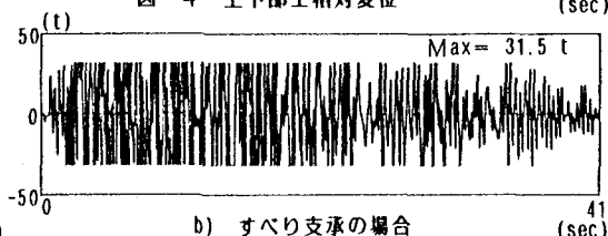
図-5 上下部工間の伝達力
