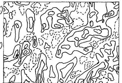
図1: FFTにより求めた速度変動の等値線図 横軸; 時間, 縦軸, 距離
