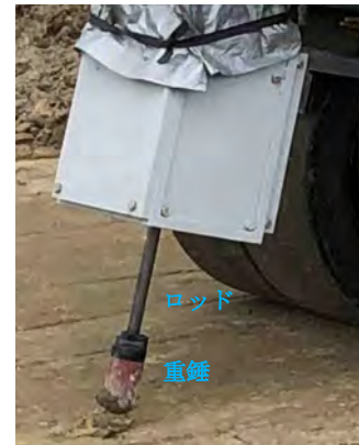
図-9 走行中の重錘とロッドの状態
