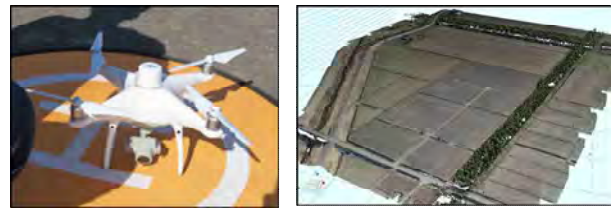
図 5 RTK-UAV (左) と解析点群データ (右)
