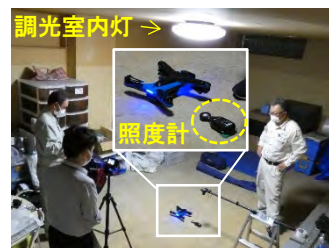
図-5 室内灯試験状況
