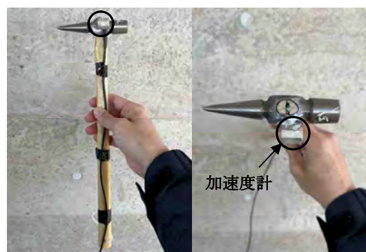
図-3 点検用ハンマーの加速度計
