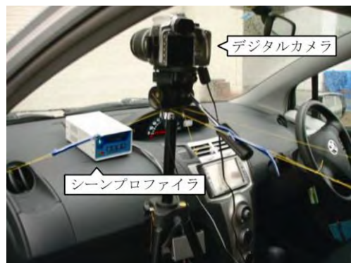
図-1 旧手法におけるカメラ設置状況
