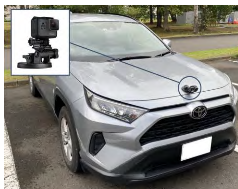
図-2 新手法におけるカメラ設置状況
