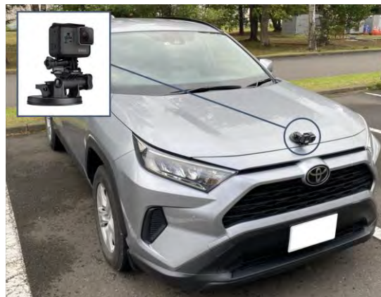
図-1 簡易カメラ搭載型舗装点検技術
