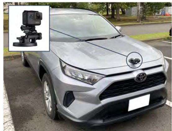
図-1 簡易カメラ搭載型舗装点検技術
