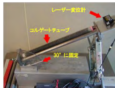
図-1 長さ変化試験装置
