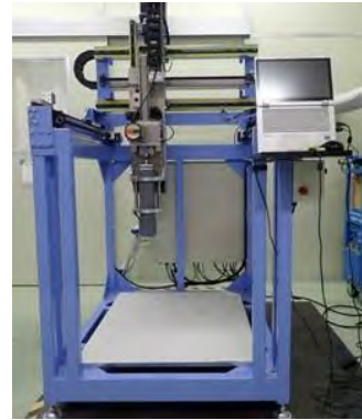
図-1 材料押出式 3D プリンティング装置
