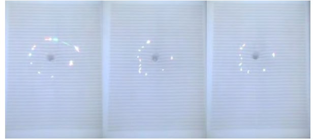
図-5 フリンジによる水面変動の観測
