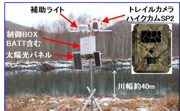
図-2 観測機器の設置状況
