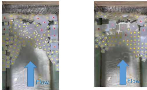
左 : caseA-⑥ 右 : caseB-⑥ 図-8 アイスジャム発生時の平面での流況
