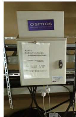
図-2 モニタリングステーション部
