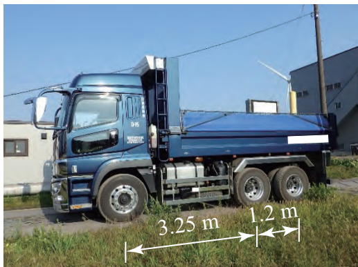
図-7 測定に用いた T20 積載車両の全景
