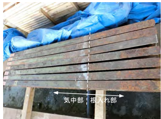
(c) 後打ちコンクリート除去後の状態
