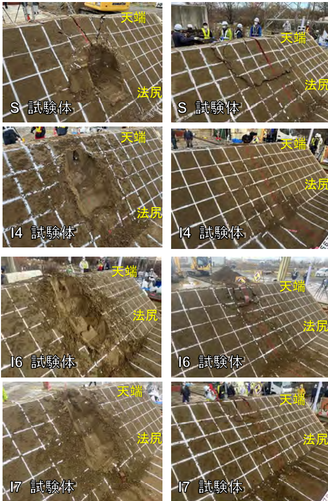
(a) 衝突面 (b) 非衝突面 写真-2 実験後の土堤状況
