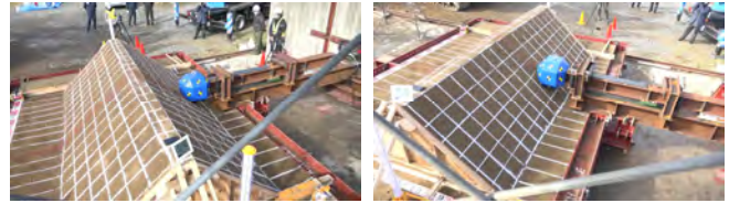
(b) 荷重点近傍に 2 つめのひび割れ発生
