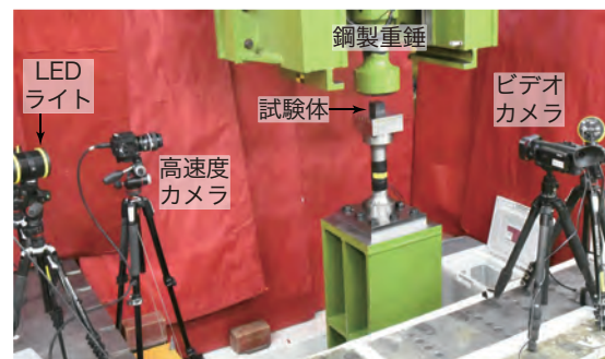
写真-1 衝撃荷重载荷実験装置の状況
